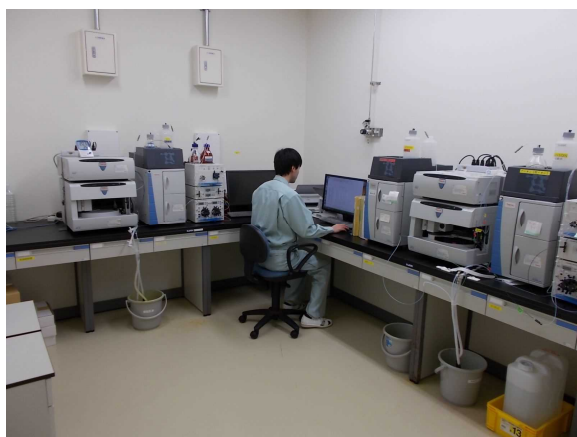
塩化物イオン等の分析(イオンクロマトグラフ分析計)
