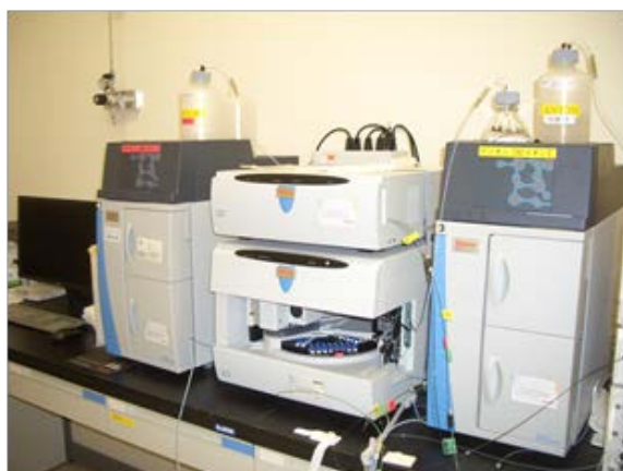
塩化物イオン等の検査(イオンクロマトグラフ)
