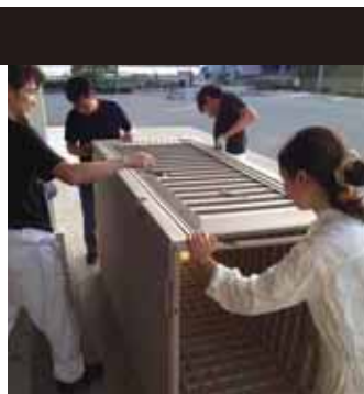
災害用トイレを組み立てる
