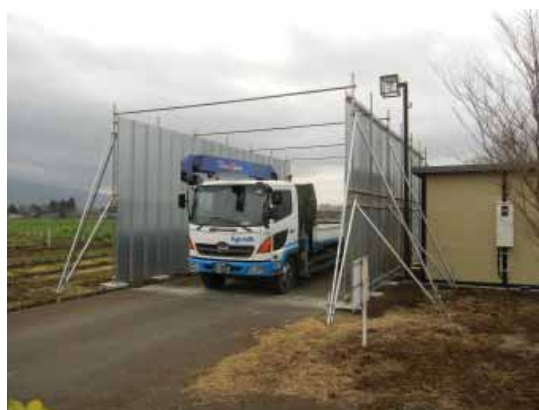
写真1 設置型車両消毒装置
