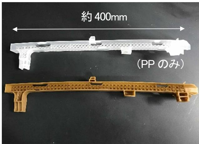
図6 自動車部材A（窓枠部材）
