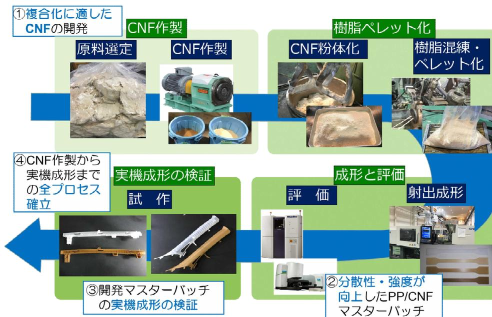
図1 CNF 作製から試作品成形までの流れ
