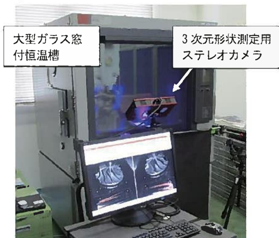
図2 開発した3次元熱変形計測システム
