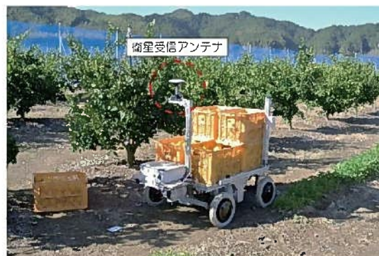
図3 衛星電波による自動走行
