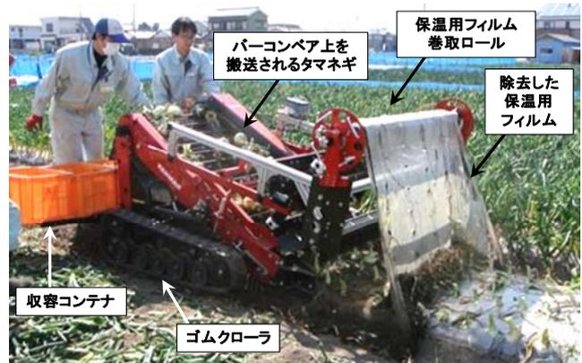
第2図 タマネギ収穫機の構造と作業状況
