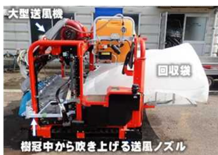
茶園用病虫害クリーナー(写真左)と、病虫害回収の概略(写真右)
