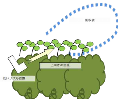
茶園用病虫害クリーナー(写真左)と、病虫害回収の概略(写真右)
