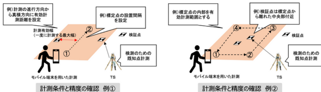
図 精度確認試験の検証条件(例)と精度比較方法(モバイル端末を用いた3次元計測技術の場合)
