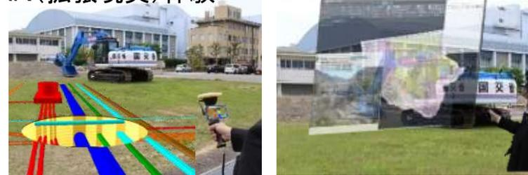
現地で簡単、安全に図面などのデータ確認ができる体験として、埋設物が風景と重ね合わせて表示される端末やカメラ付眼鏡型表示端末の体験ができます。
