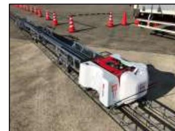
鉄筋運搬ロボット
