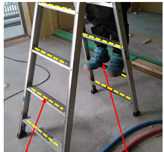
脚立のステップにすべり止めを貼り付け
