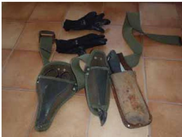
図一 8 被災者の要求性能墜落制止用器具（安全帯）等の状況
