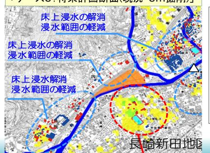
·河床掘削(現況 -3m)等の整備を 行うことで、浸水 深45cm以上の メッシュ数は約 92%減少するが 清水地区におい ては基本方針断 面(現況-3m)ま で掘削しても、床 上浸水被害の解 消には至らない
