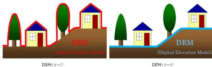
図 3-11 DSM と DEM のイメージ
