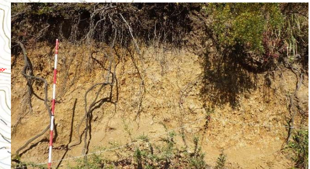
Brコアで確認されたものと同じ強風化安山岩 溶岩の露頭
