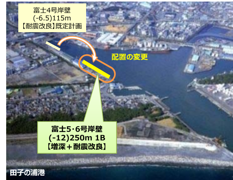
田子の浦港 緊急物資輸送用耐震強化岸壁の配置変更計画
