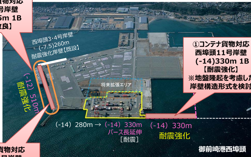
御前崎港RORO・バルク対応耐震強化岸壁の整備計画図
