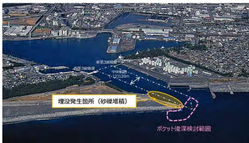
図 4-11 田子の浦港中央航路の埋没対策実施状況
