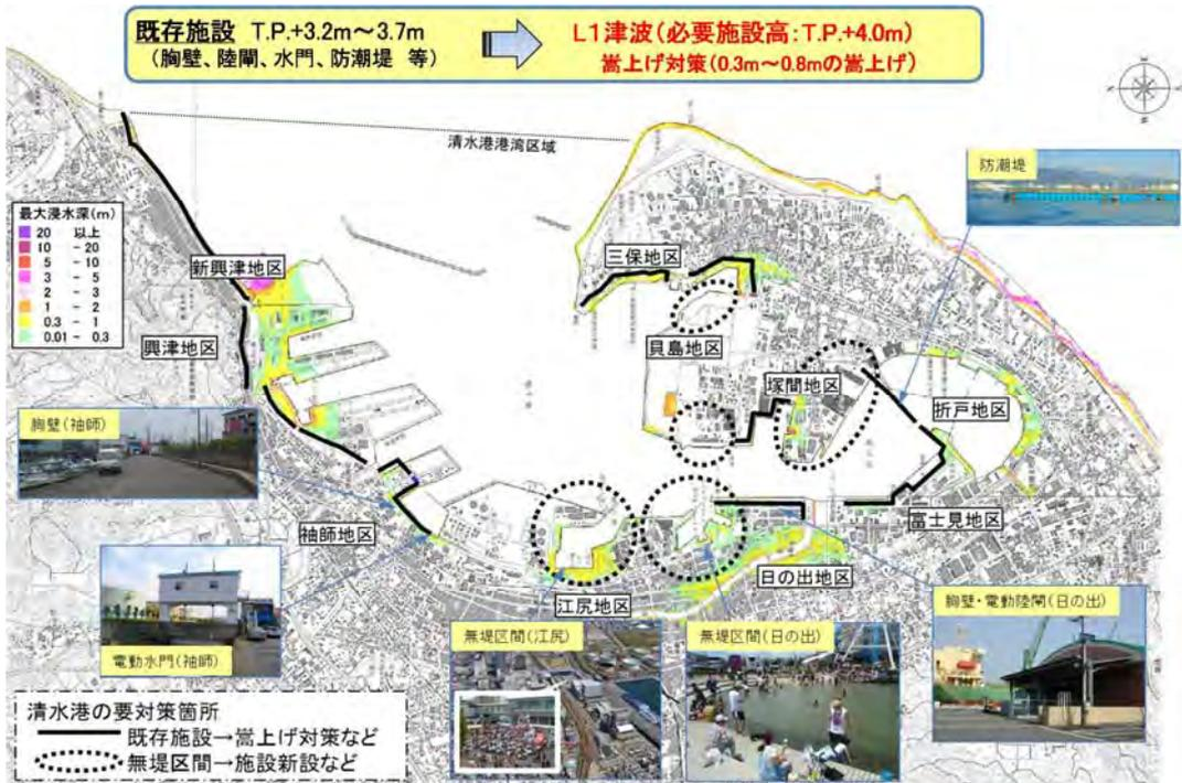
図 4-2 清水港の津波防護ラインの強化イメージ
