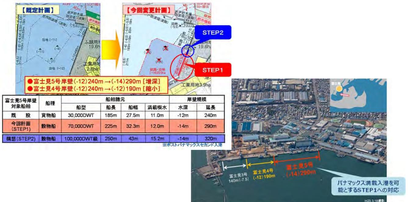
図 3-10 清水港富士見埠頭の大型輸入穀物船対応ターミナルの整備イメージ
