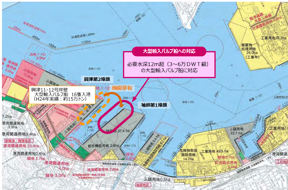
図 2-33 清水港の大型輸入パルプ船対応ターミナルの整備イメージ
