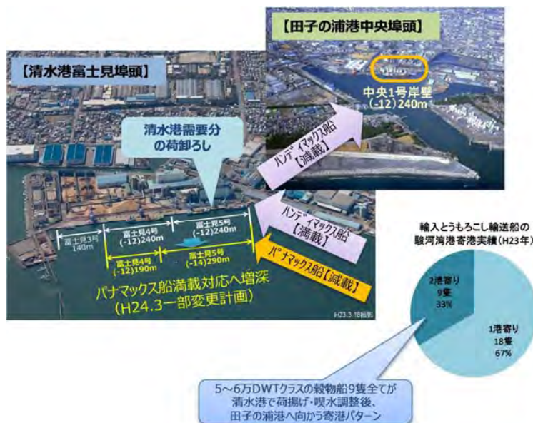
図 2-27 駿河湾港の輸入穀物の輸送状況
