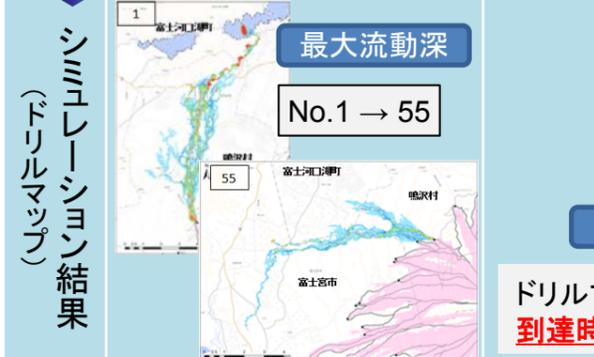
計算開始点は、火砕流の流下によって発生した融雪水が谷に集まっていくものと考え、「**火砕流の下流端付近の谷底**」として、**平成16年版の約3倍となる55地点を設定**
