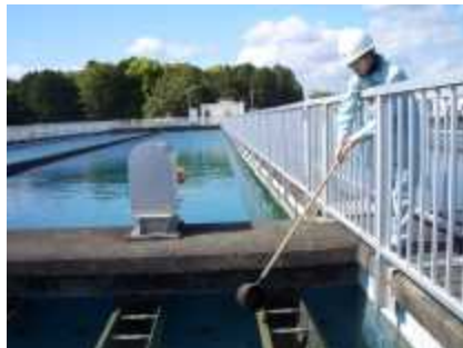
浄水工程の水質検査用の採水
