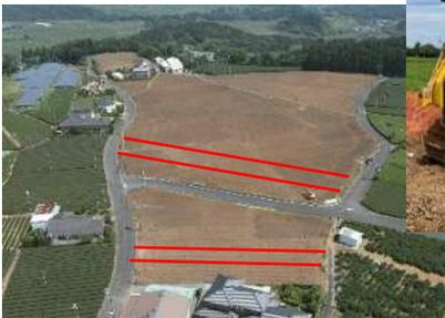
ICT対応型建機による暗渠排水管の敷設
