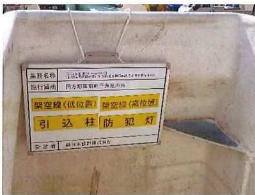
高所作業車バケット内への掲示例
