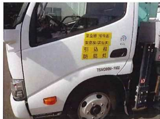
高所作業車車体への表示例
