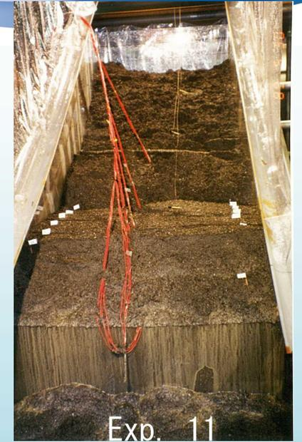
川砂斜面による崩壊実験
