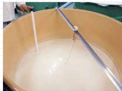
貯蔵タンクはセンサーで温度管理
