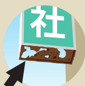
側板底面の腐食、破損
