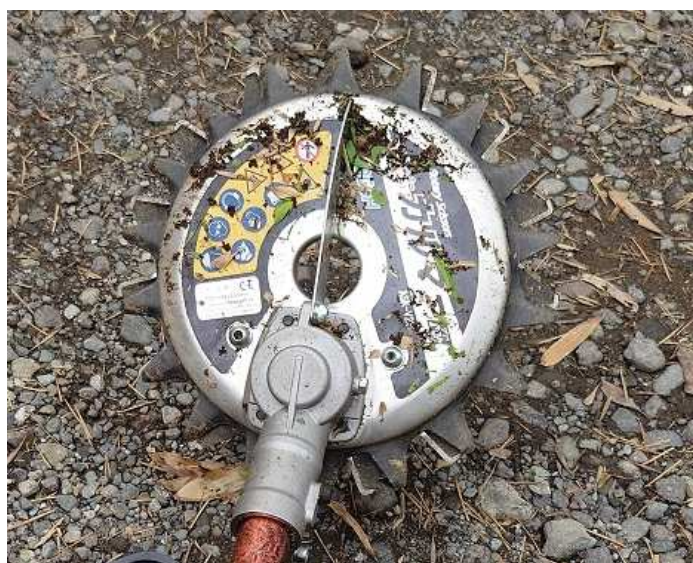
上下の刃が逆回転しハサミ構造になるため 飛散しにくい
