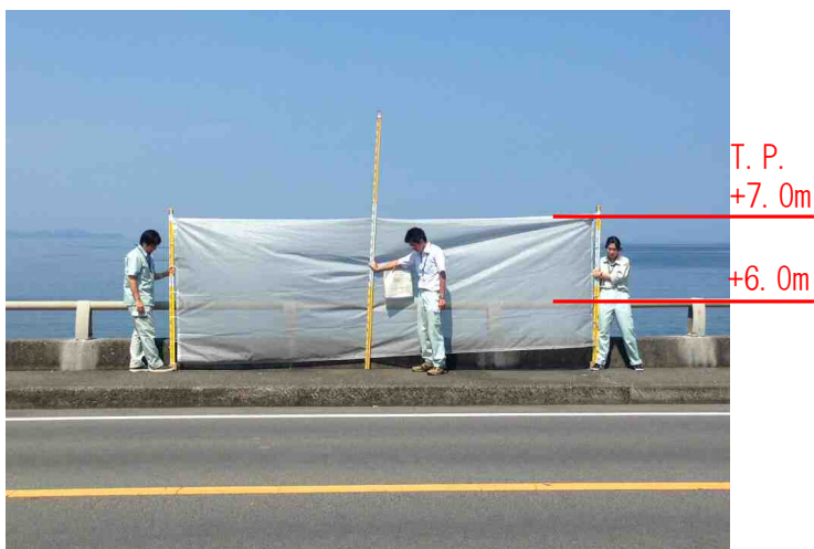
T. P. +7. 0m (L1) 壁高1. 80m (欄干上部 約T. P. +6. 0m 壁高約80cm)
