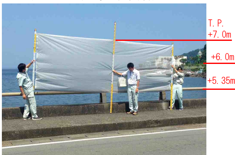
T. P. +7. 0m (L1) 壁高2. 45m (欄干上部 約T. P. +5. 35m 壁高約80cm)
