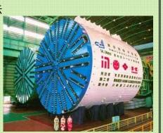
いく工法です。この工法は軟弱で崩れやすい土質に適しています。東京湾アクアラインは、シールド工法によりつくられています。
