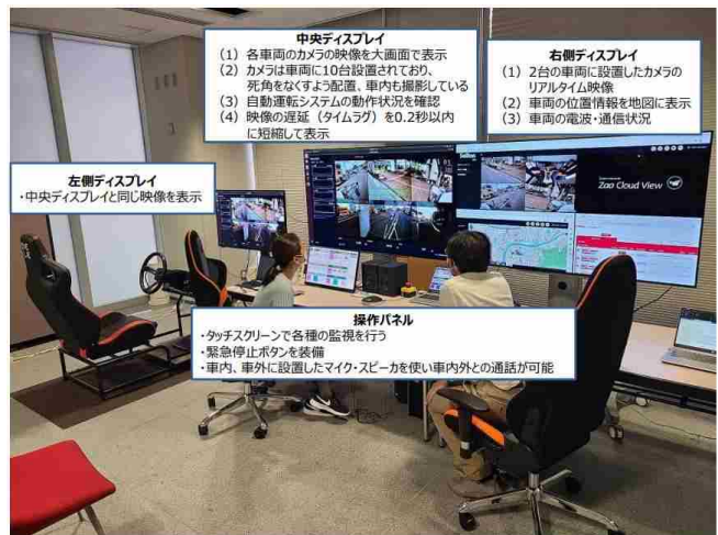
▲遠隔コントロールセンターの機能
