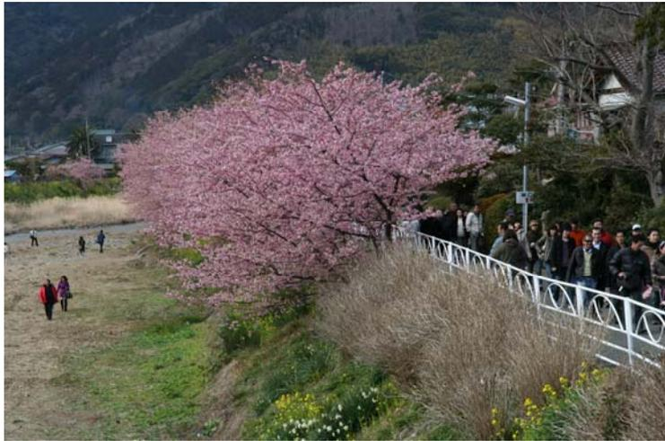
その一方で、堤防に植栽された河津桜は河川区域内における樹木の植樹基準を満たしておらず、暴風時の倒木、腐った根の周辺に空洞ができるなど、堤防を弱体化させる可能性もあります。
