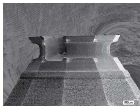
▲開発したエンドミル 割れ目から削りカスが排出される
