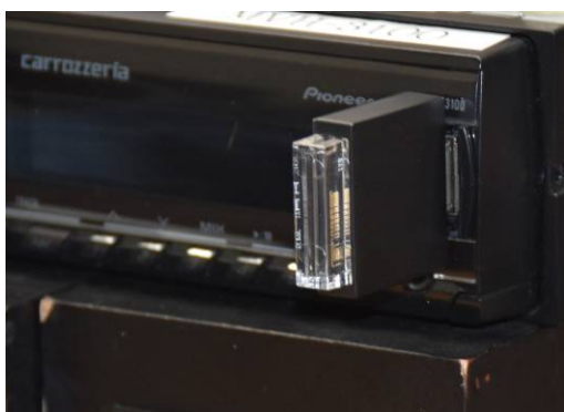
▲「OKARA oc.1」 Bluetoothに対応していない車でもUSBで接続し音楽を流すことができる
