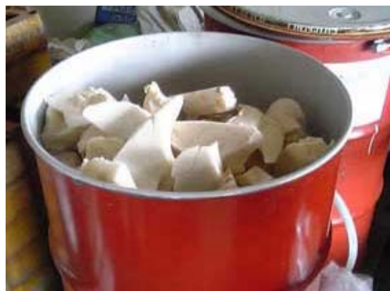
▲ドラム缶1缶で約10㎡の発泡スチロールを溶解することができる。
