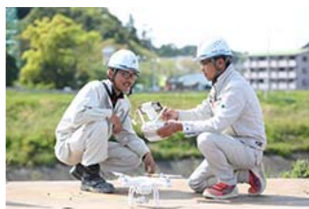
▲現場の記録や空中測量などにドローンを活用し、作業効率の大幅アップを実現している。
