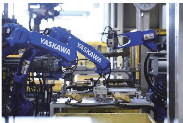
▲作業用ロボットにより砂を固めて中子を作る様子
