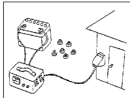
(4) 12Vバッテリが放電してしまい、エンジンの始動や本機の電源を入れることが出来なくなった場合は、ブースタケーブルの使用はせず、バッテリを交換するか、本機から取り外して充電してください。
