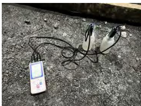
図 4 4 ボーリング湧水の水質測定
