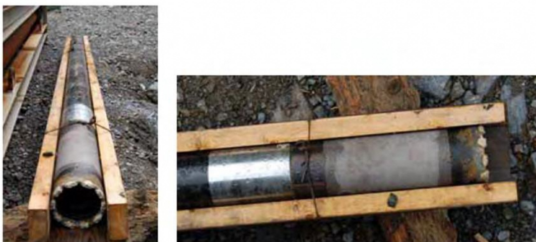
写真 1 コア採取ツール (コアチューブ：参考)
