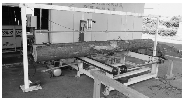
図 1 高周波電磁波およびガンマ線を利用した丸太含水率を推定する装置
