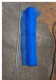
①直管パイプと防風ネット
