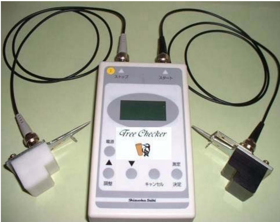
開発した立木強度測定器「Tree Checker」
