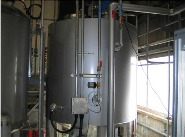
▲ 写真1 原料の糖化兼発酵槽
