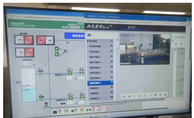
農業用排水機場の遠隔監視システム
