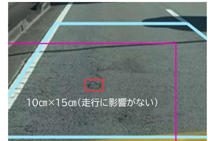
AIが検知した路面変状(穴ぼこ)
