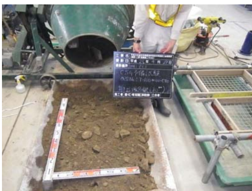
室内試験（CSG 配合試験）
