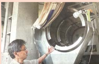
香りを高めるために生葉を攪拌する装置
