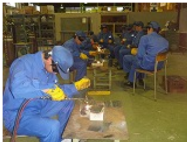
ガス溶接作業
