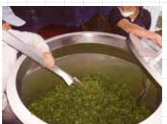
高GABA茶生産現場における嫌気処理槽内の茶葉の状態確認の様子。
