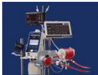
静岡県内の工場で生産されている経皮的な心肺補助システム(PCPS/ECMO)。心停止などの緊急症例に対する治療で、遠心ポンプと膜型人工肺を用いた人工心肺装置により、患者さんの心臓と肺の代わりの役割を果たす。
