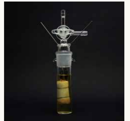
1983年に吉野氏が試作した電池第一号のレプリカ。
