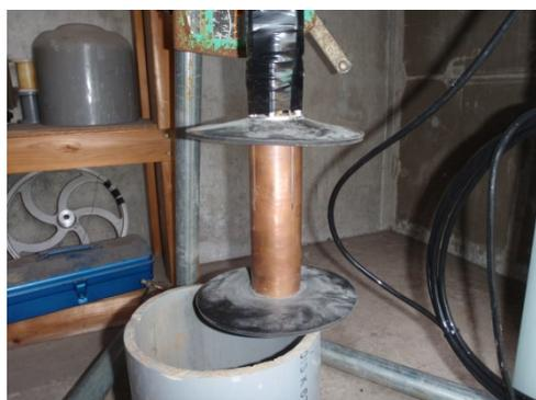
写真 2-1 孔内熱交換能力測定器
