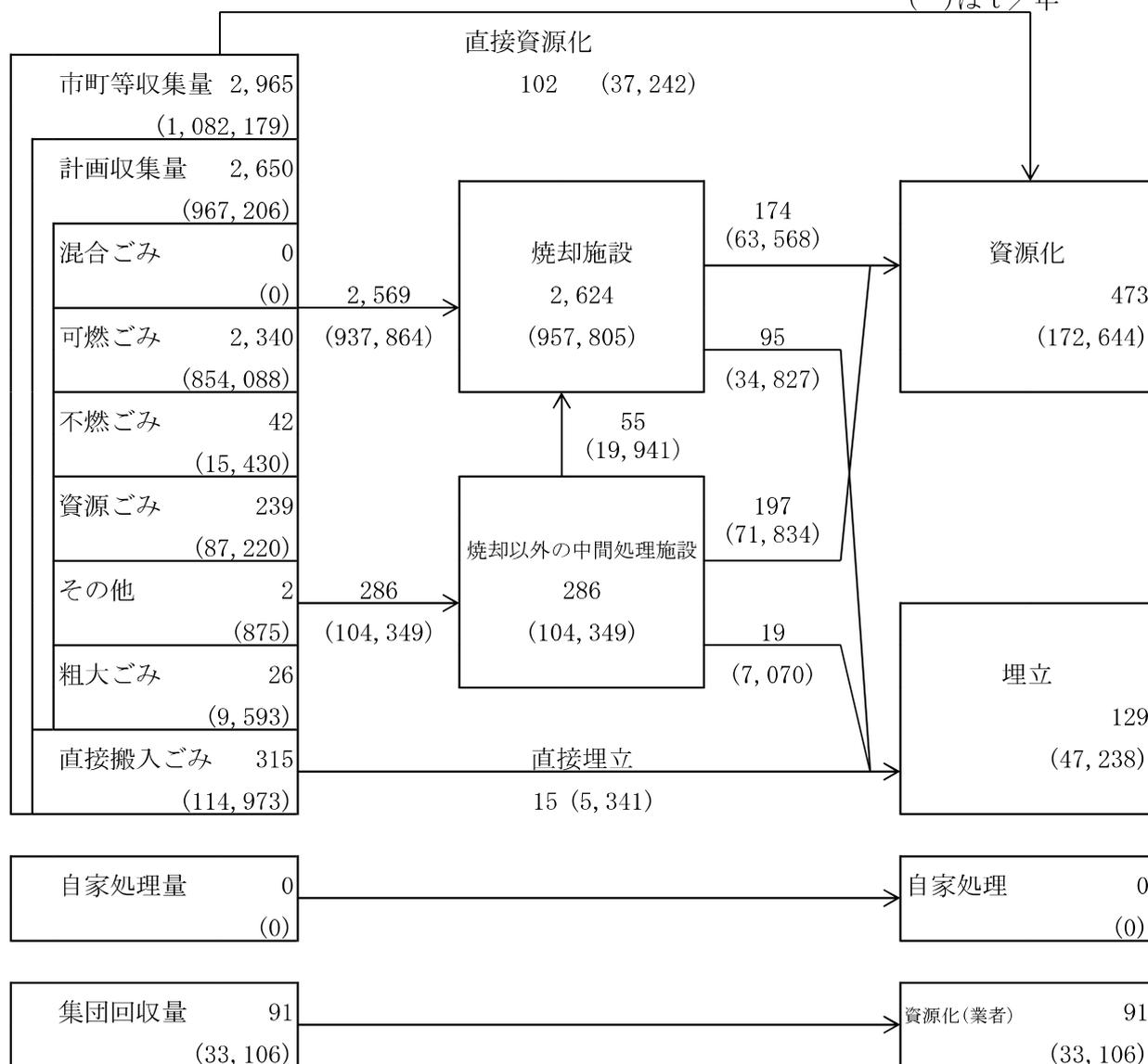
※収集と処理の時期の相違により「市町等収集量」と、「直接資源化」、「焼却施設」、「焼却施設以外の中間処理施設」、「直接埋立」の合計は一致しない。
