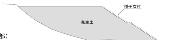
図 発生土置き場における施工概要
